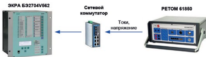
Рис. 6. Схема подключения терминала ДЗШ к установке РЕТОМ 61850 для проведения функциональных испытаний
