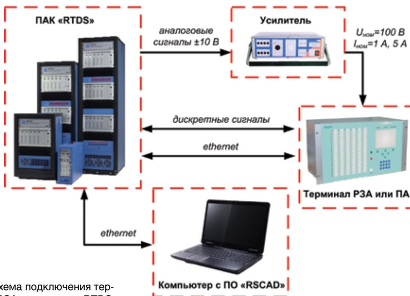
Рис. 2. Схема подключения терминала РЗА к комплексу RTDS
